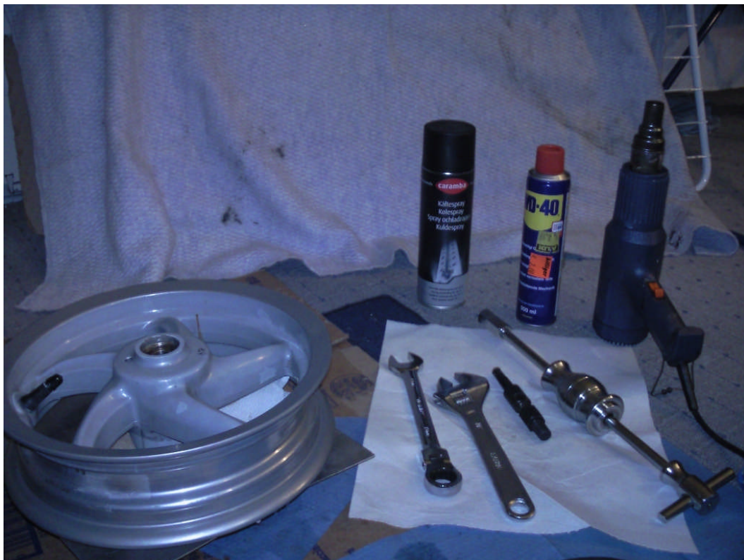
Hier die Zip-Felge, Kältespray (bis -50^{\circ}\text{C} , war etwas teurer) WD40, Heißluftfön, Maulschlüssel (SW19), Engländer (SW auf 17), Ausziehwerkzeug, Gleithammer (Bild 2)
